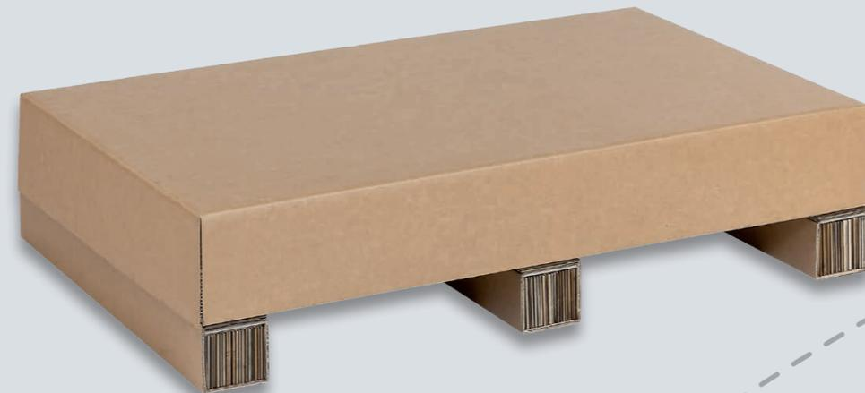
Die **SiBOXXair** ist eine rundum flächenbündige und umweltfreundliche Kartonverpackung, die eine Manipulation sofort erkennen läßt. Kanten und Deckel sind mit **Spezialkleber** vorbehandelt, dieser klebt nach dem Abziehen der Schutzfolie fest und flächenbündig. Der gesamte Unterboden ist ebenfalls flächenbündig ausgebildet und verklebt. Die Kufen sind aus Wellpappe und werden, ebenso wie der Deckel, durch Umreifungsband zusätzlich gesichert.
